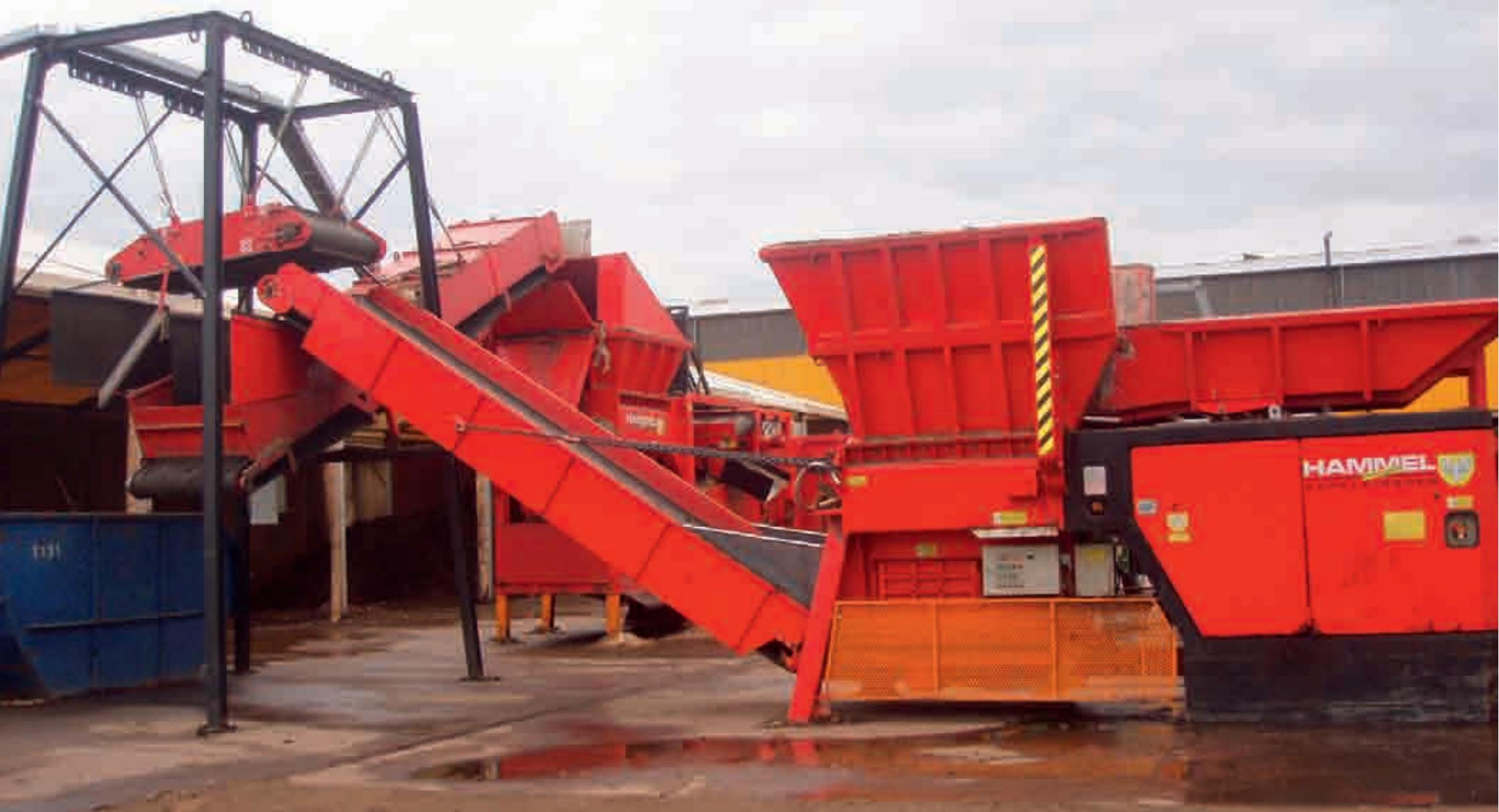
Material wird in den VB 750 E aufgegeben und vorzerkleinert. – Das vorzerkleinerte Material passiert den Permanent-Überbandmagneten und FE-Anteile werden separiert und gesondert ausgetragen. – Im Anschluss erfolgt die NE-Abscheidung. – Über ein Zuführband wird das metallfreie Material der zweistufigen NZS 700 E zugeführt und auf das definierte Endkorn zerkleinert.
