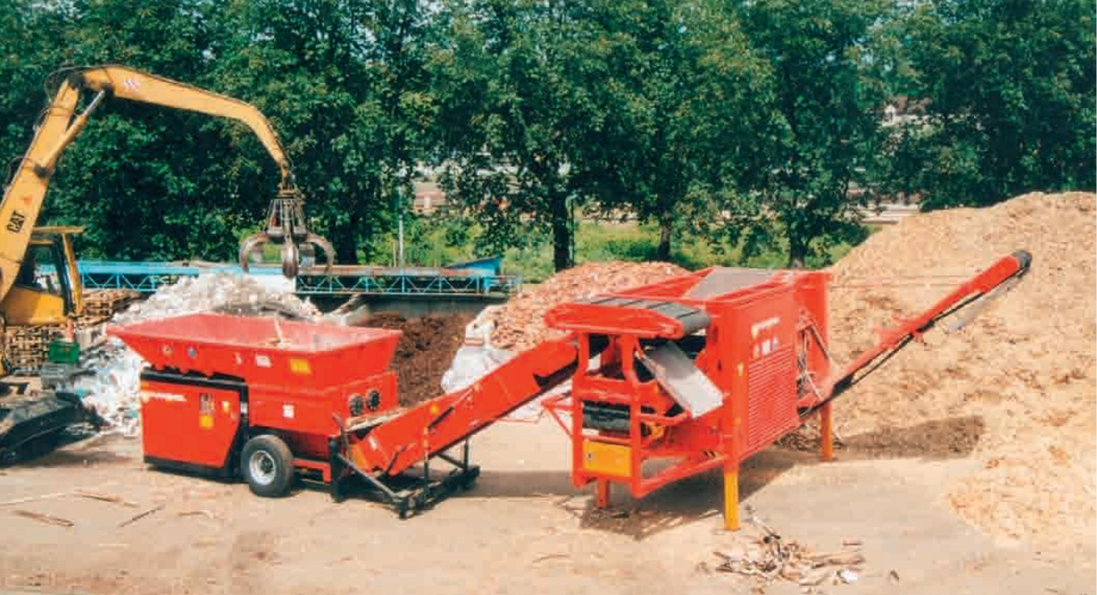
Das Material wird in den VB 750 D aufgegeben, vorzerkleinert und durch den verbauten Permanent-Überbandmagneten von FE-Anteilen befreit. – In der Nachzerkleinerung NZS 700 D ist ein Metalldetektor zur Erkennung der NE-Anteile verbaut, welcher durch eine Ausschleusklappe die erkannten Anteile entfernt. – Das metallfreie Material wird in der Nachzerkleinerung weiter aufbereitet und ausgetragen.
