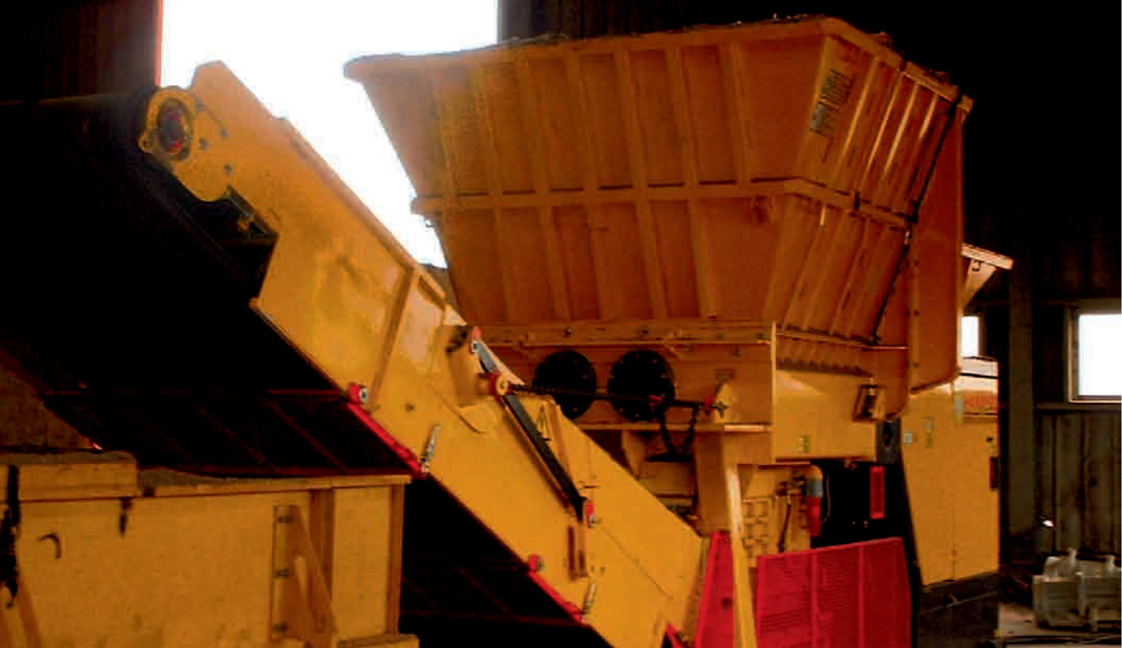
Material wird in den VB 750 E aufgegeben und vorzerkleinert. – Das vorzerkleinerte Material wird über das Austragsband und die Übergabeschurre der weiteren Aufbereitung zugeführt.
