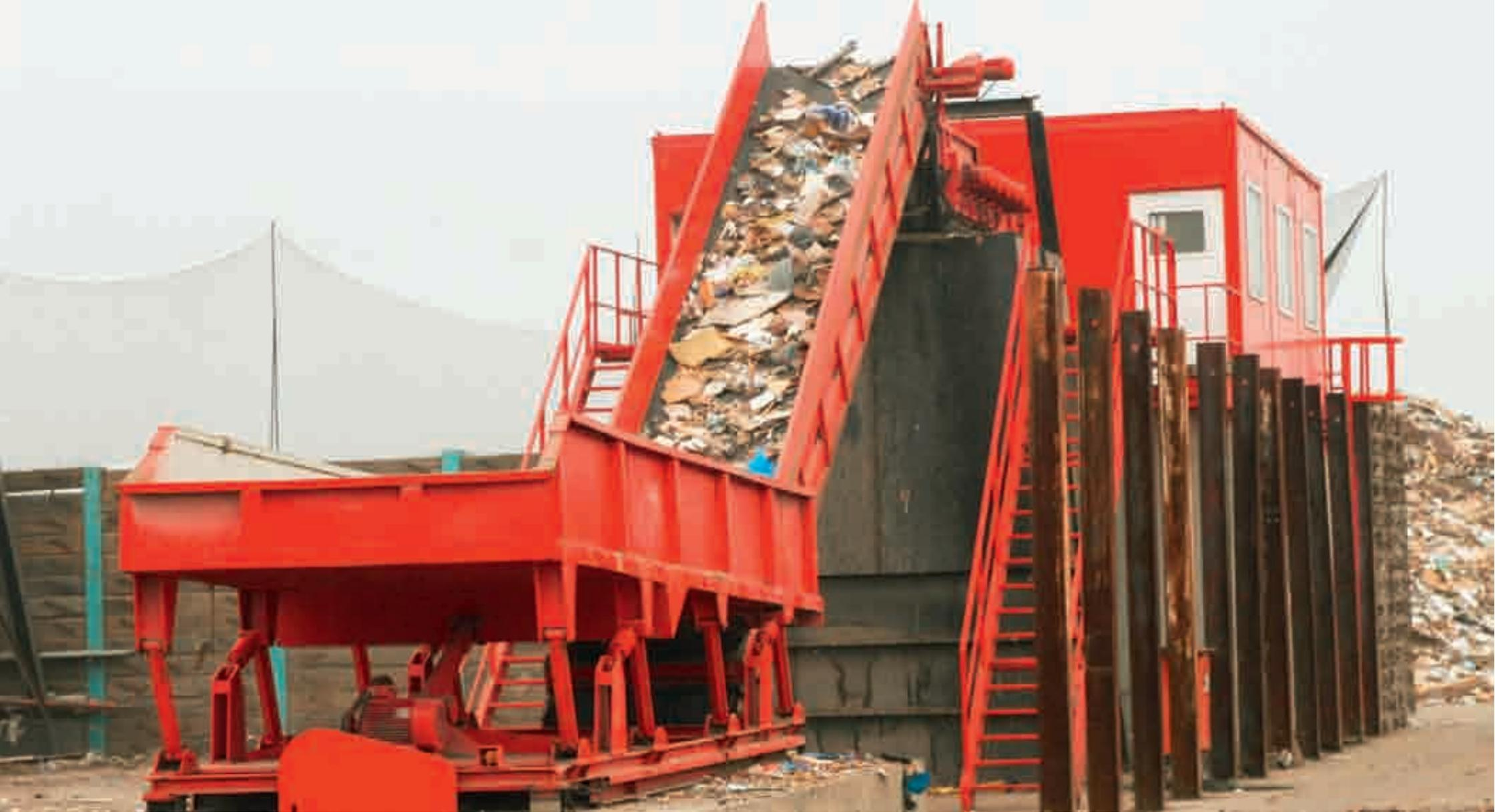
Das Material wird auf die Vibrorinne aufgegeben und entzerrt. – Das aufgelockerte Material wird über ein Steigeband zum Rollensieb befördert. – Es erfolgt die Absiebung des Feianteils von 0 bis 120 mm. – Das Überkorn wird über das Sortierband in die Sortierkabine befördert und manuell aussortiert. – Das Restmaterial wird über das Sortierband in den Bunker ausgetragen.
