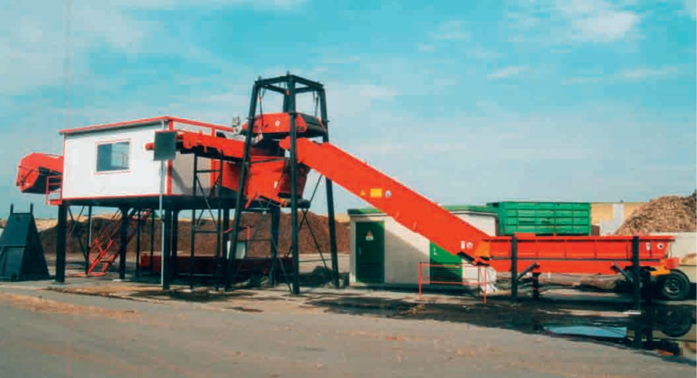
Das Material wird auf den Zuführbunker aufgegeben und läuft über ein Steigeband zum Elektro-Überbandmagneten. – Das FE-freie Material läuft über das Sortierband in die Sortierkabine. – Das Restmaterial passiert den Metalldetektor, wo NE-Anteile ausgeschleust werden. – Das metallfreie saubere Material steht der weiteren Verwertung zur Verfügung.
