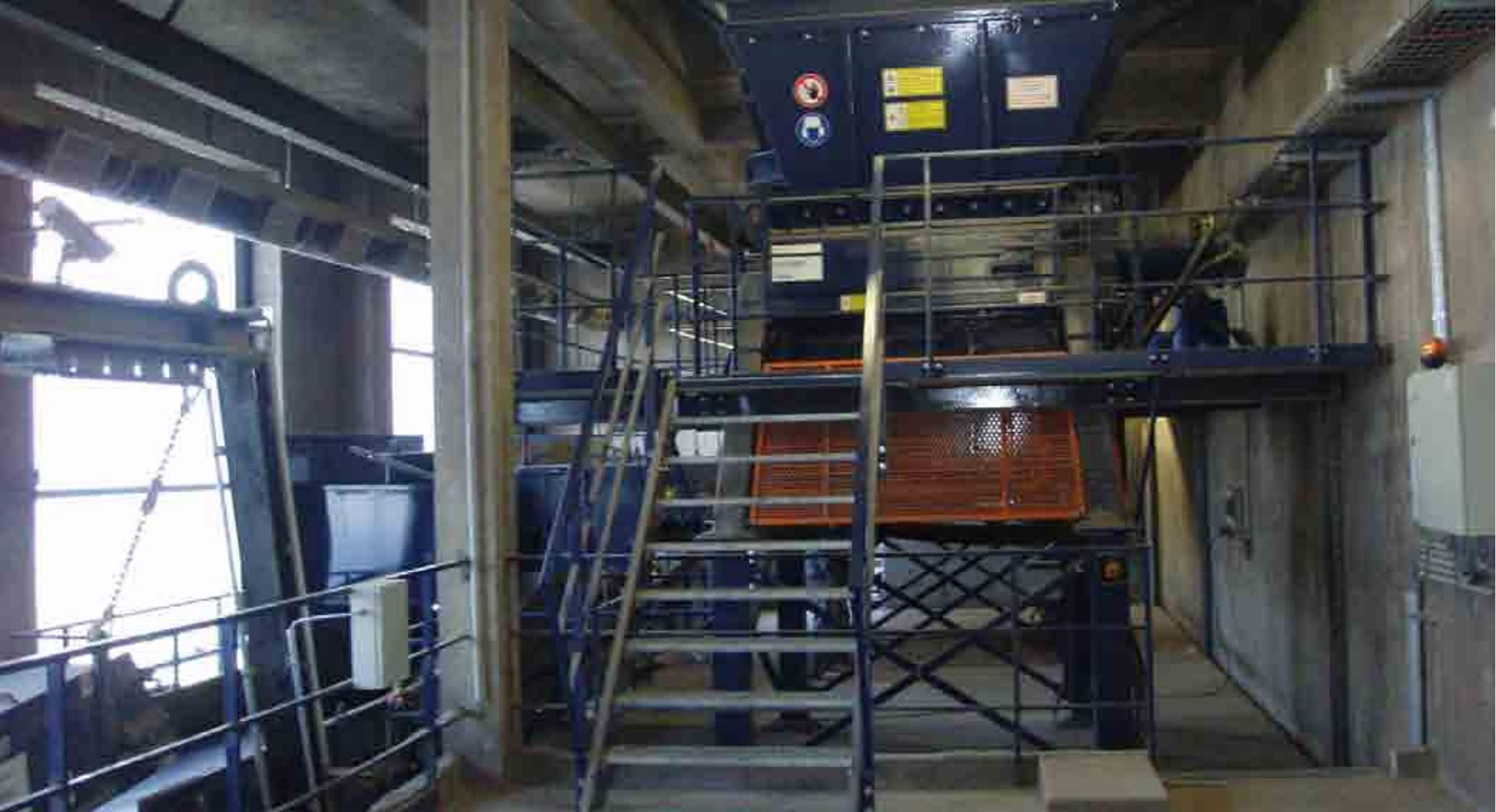
Das Material wird in eine von zwei separaten Zerkleinerungseinheiten mit speziellem Einfülltrichter aufgegeben und vorzerkleinert. – Das vorzerkleinerte Material fällt auf das Querband mit Vorwärts-/Rückwärtslauf und wird zum Elektro-Überbandmagnet befördert. – Das vorzerkleinerte FE-freie Material steht der weiteren Aufbereitung zur Verfügung.
