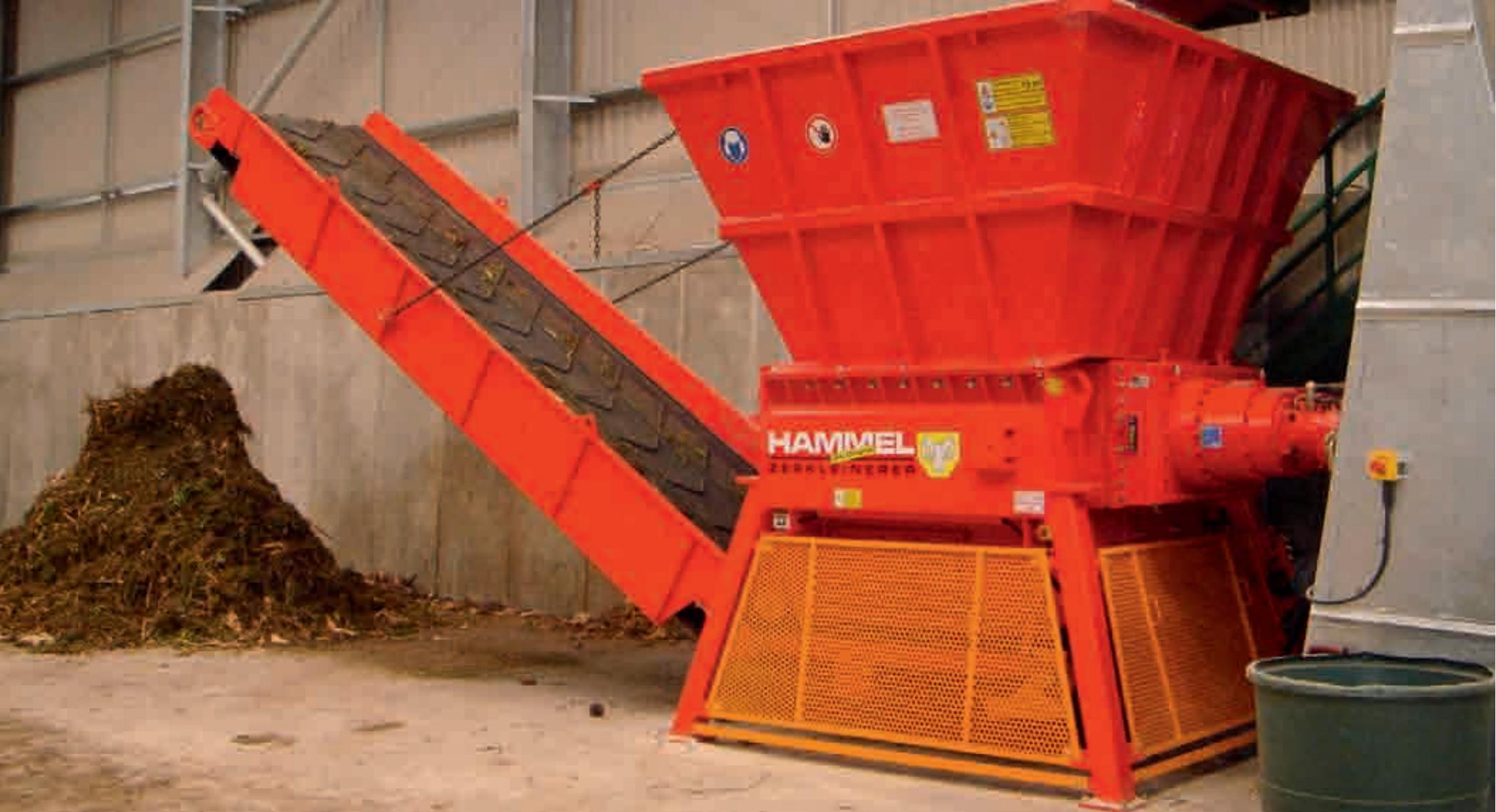
Das Material wird in den erhöhten Trichter der separaten Zerkleinerungseinheit aufgegeben und vorzerkleinert. – Über das Austragsband wird das Material für die weitere Verwendung ausgetragen.
