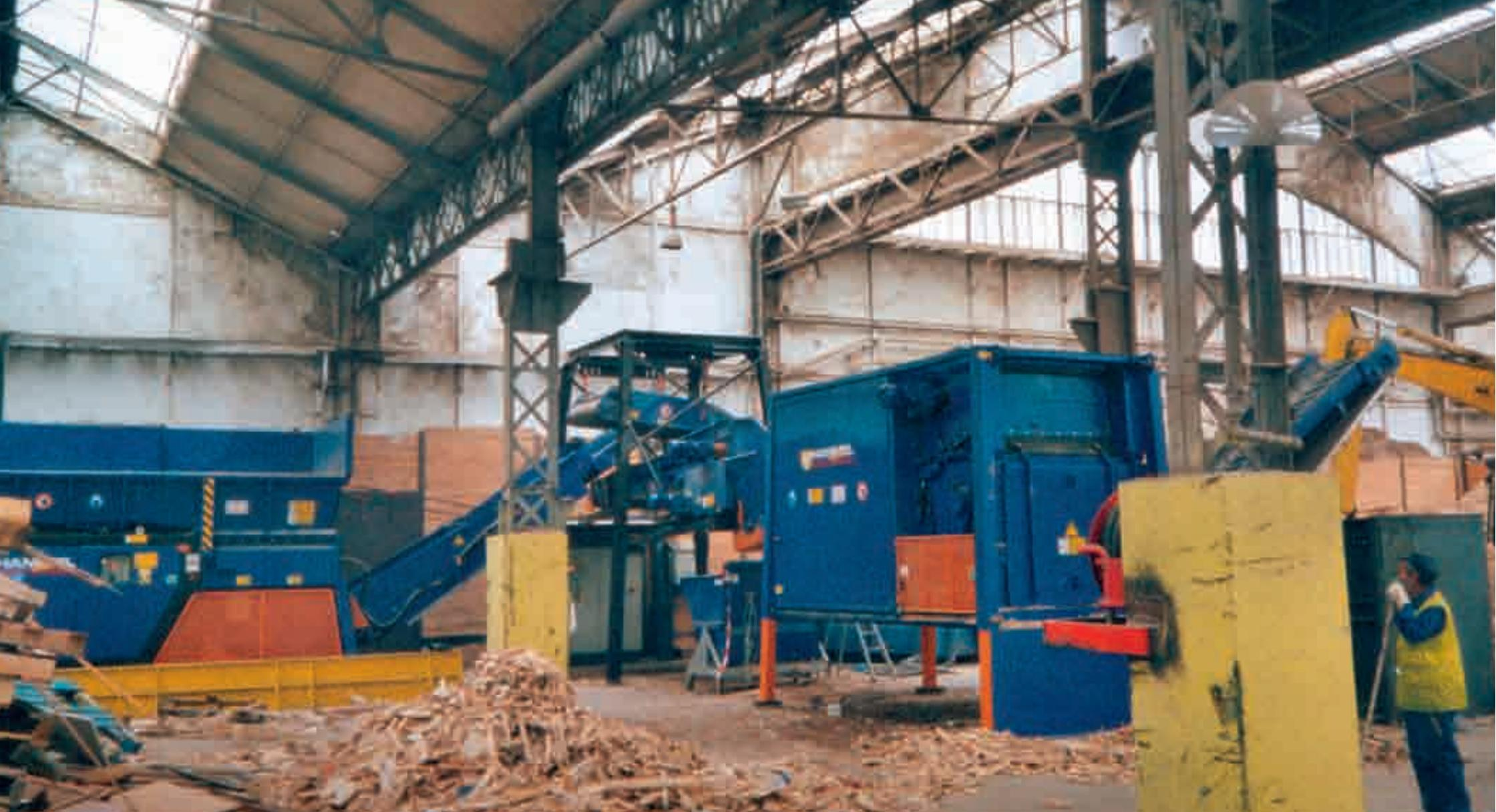
Das Material wird in den VB 750 E aufgegeben und vorzerkleinert. – Über das Austragsband läuft das vorzerkleinerte Material zum Elektro-Überbandmagneten, wo die FE-Anteile separiert und gesondert ausgetragen werden. – Das FE-freie Material wird über ein Zwischenband zum Rollensieb transportiert und läuft nach der Absiebung von 0 bis 15 mm erneut auf ein Zwischenband und wird der NZS 700 E zugeführt, auf das definierte Endkorn zerkleinert und ausgetragen.
