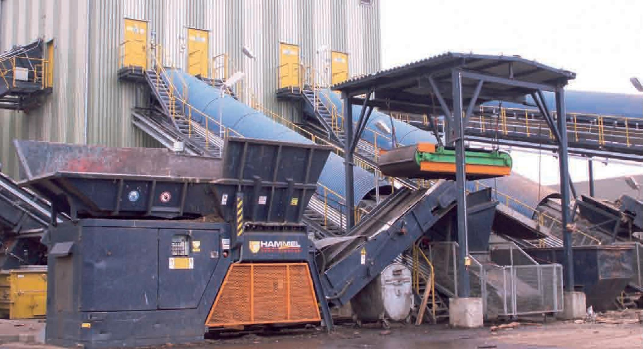
Material wird in den VB 750 E aufgegeben und vorzerkleinert. – Das vorzerkleinerte Material passiert den Permanent-Überbandmagneten und FE-Anteile werden separiert und gesondert ausgetragen. – Über das Austragsband wird das Material der weiteren Aufbereitung und späteren Verbrennung zugeführt.
