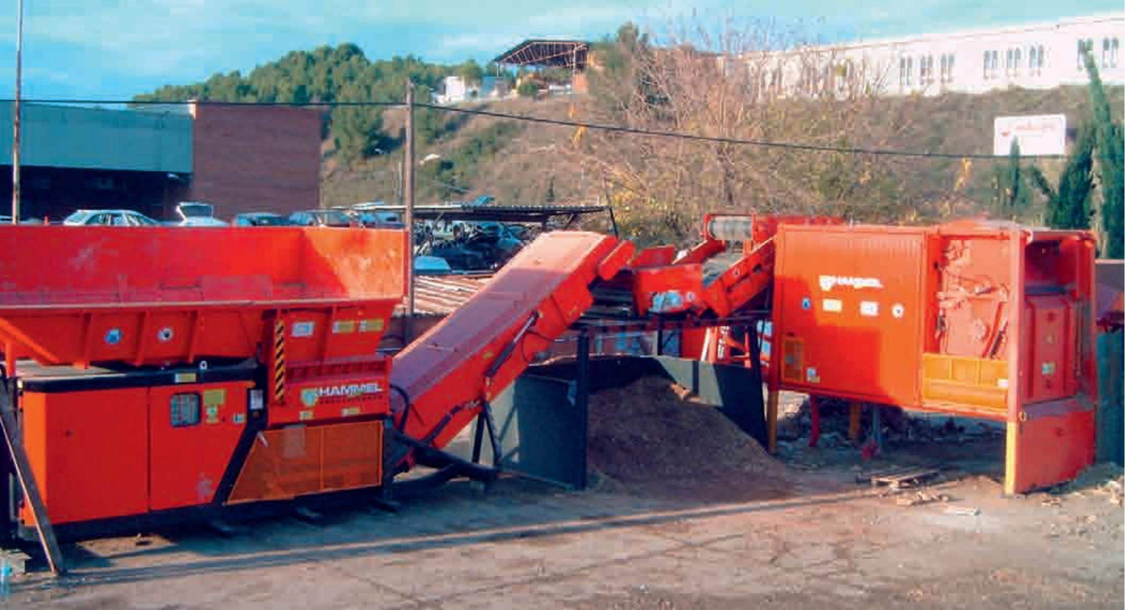
Das Material wird auf den VB 750 E aufgegeben und vorzerkleinert. – Über das Austragsband gelangt das Material direkt auf das Rollensieb und wird von 0 bis 20 mm großen Feinanteilen befreit. – Das Überkorn wird über das Zwischenband zum Permanent-Überbandmagneten befördert und von FE-Anteilen befreit. – Das FE-freie Material wird direkt in die NZS 700 E zur Nachzerkleinerung und NE-Abscheidung weitergeleitet. – Der metallfreie saubere Span wird über ein schwenkbares Haldenband ausgetragen.
