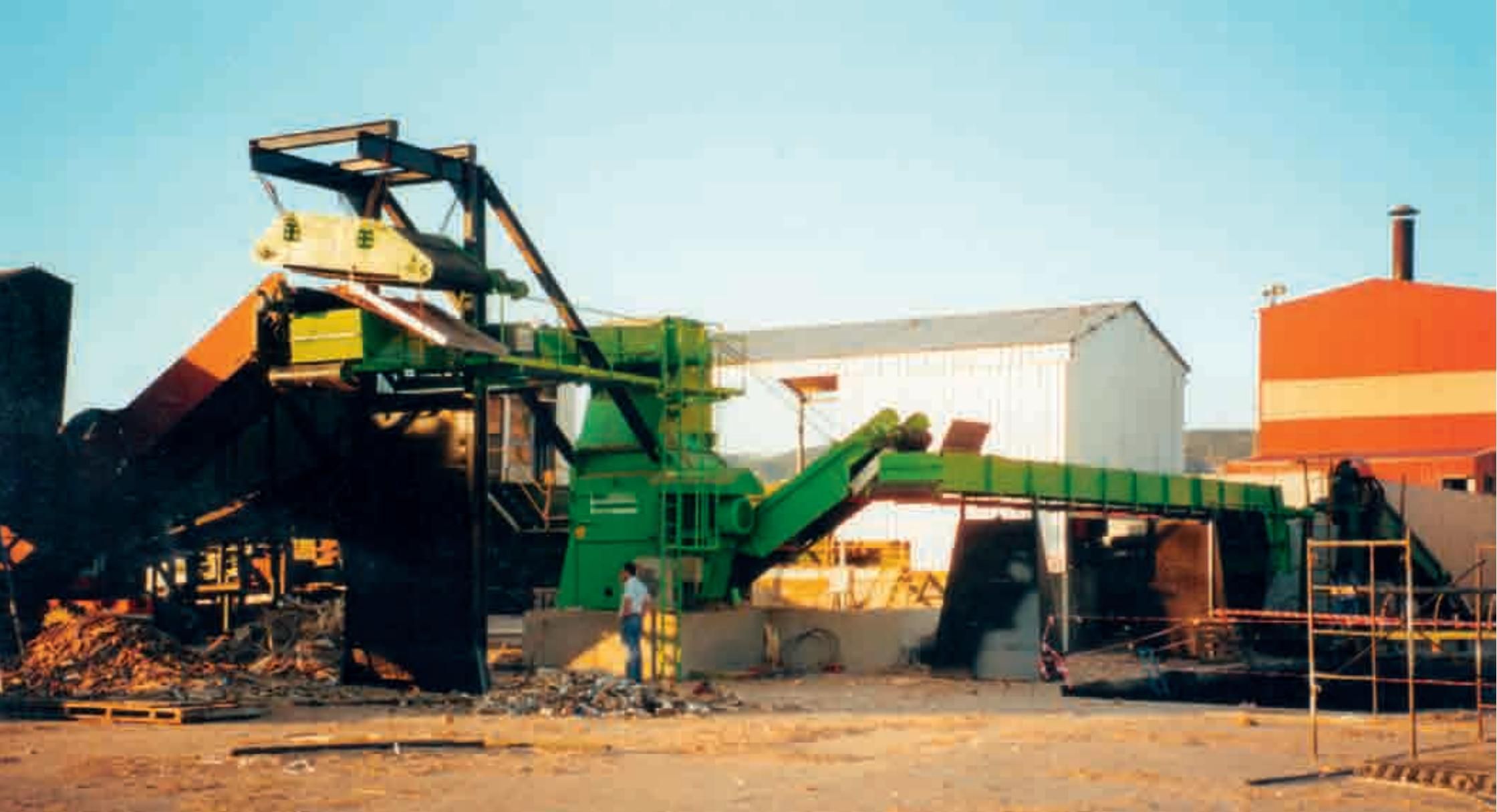
Das zu zerkleinernde Material wird in den VB 650 D-/IS aufgegeben, vorzerkleinert und auf das Zuführband zur NZS 1000 E übergeben. – Über das Zuführband passiert das Material den Elektro-Überbandmagneten, wo die FE-Anteile separiert und gesondert ausgetragen werden. – Das FE-freie Material wird in die NZS 1000 E befördert. – Der metallfreie Span wird über das Transportband der weiteren Verwertung zugeführt.
