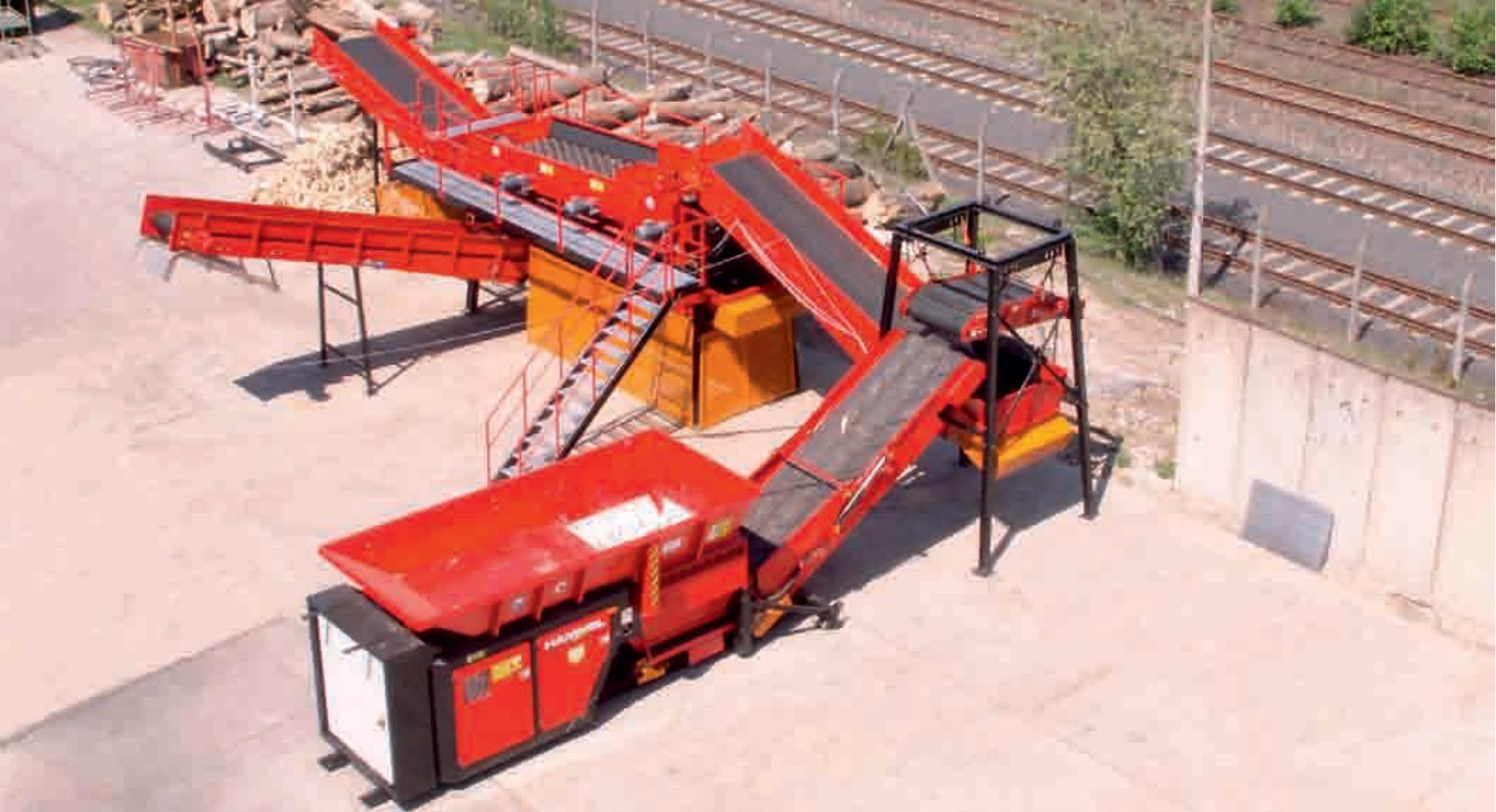
Das Material wird auf den VB 750 E aufgegeben und vorzerkleinert. – Über das Austragsband läuft das vorzerkleinerte Material zum Permanent-Überbandmagneten, wo die FE-Anteile separiert und gesondert ausgetragen werden. – Das FE-freie Material wird über ein Zwischenband zum Scheibensieb transportiert. – Mit dem Scheibensieb wird eine Fraktion von 0 bis 60 mm abgesiebt. – Unter- und Überkorn werden separat ausgetragen.
