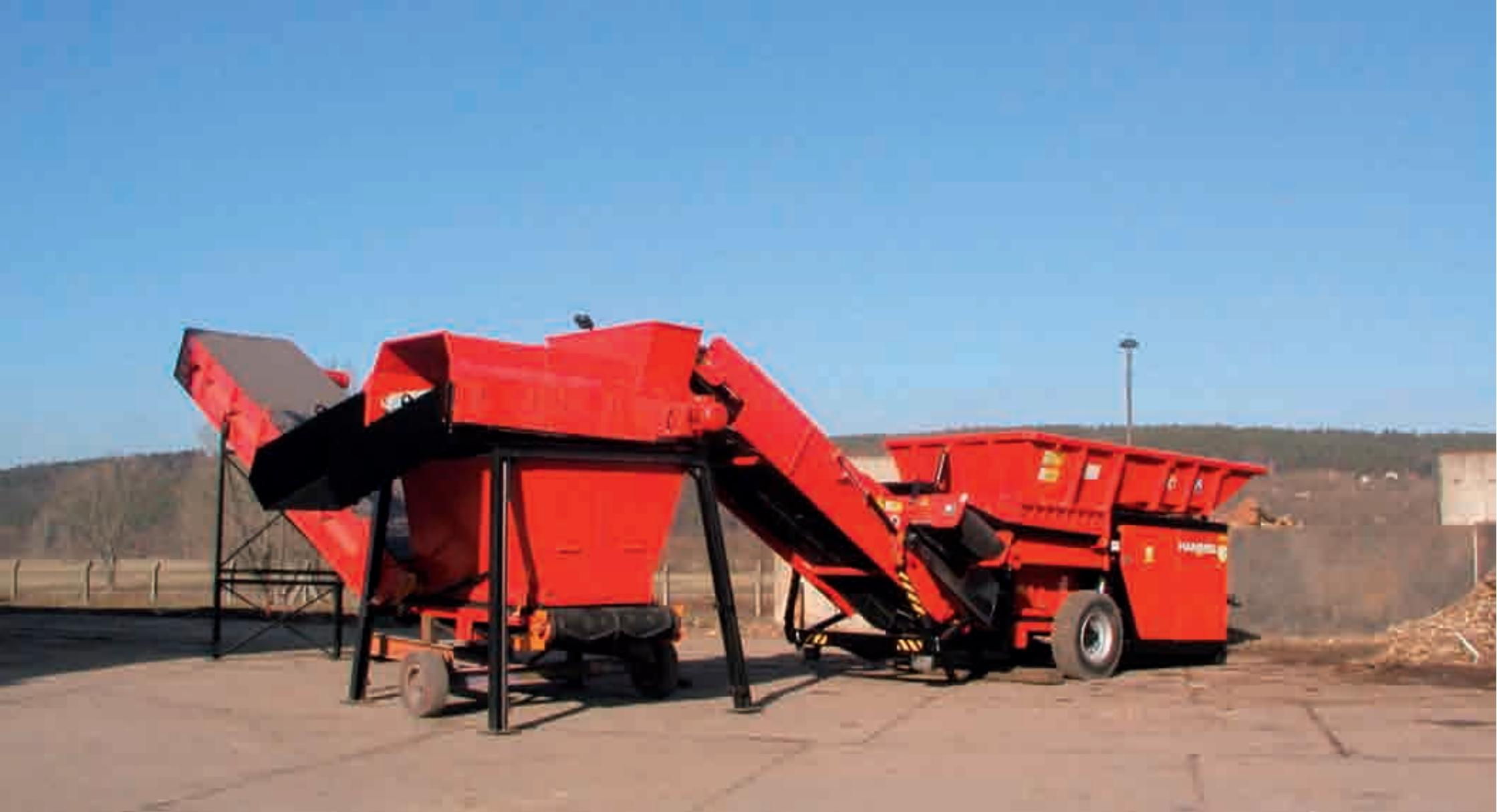
Das Material wird in den VB 750 E aufgegeben, vorzerkleinert und durch den verbauten Permanent-Überbandmagneten von FE-Anteilen befreit. – Durch das Austragsband wird das vorzerkleinerte Material auf das Scheibensieb befördert und mit der Fraktion 0 bis 120 mm abgesiebt. – Das Unterkorn wird über das Austragsband und das Überkorn über die Schurre ausgetragen.
