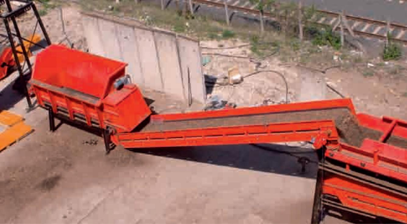
Das bereits zerkleinerte Material wird in den Aufgabebunker aufgegeben. – Es entsteht ein gleichmäßiger Materialfluss. – Über das verlängerte Austragsband wird das Material dem Sternsieb übergeben. – Es erfolgt eine Absiebung der Feianteile 0 bis 10 mm. – Das Überkorn fällt auf das Querband und wird ausgetragen. – Die abgeseibte Fraktion wird durch ein unterhalb des Siebes verbautes Austragsband separiert.
