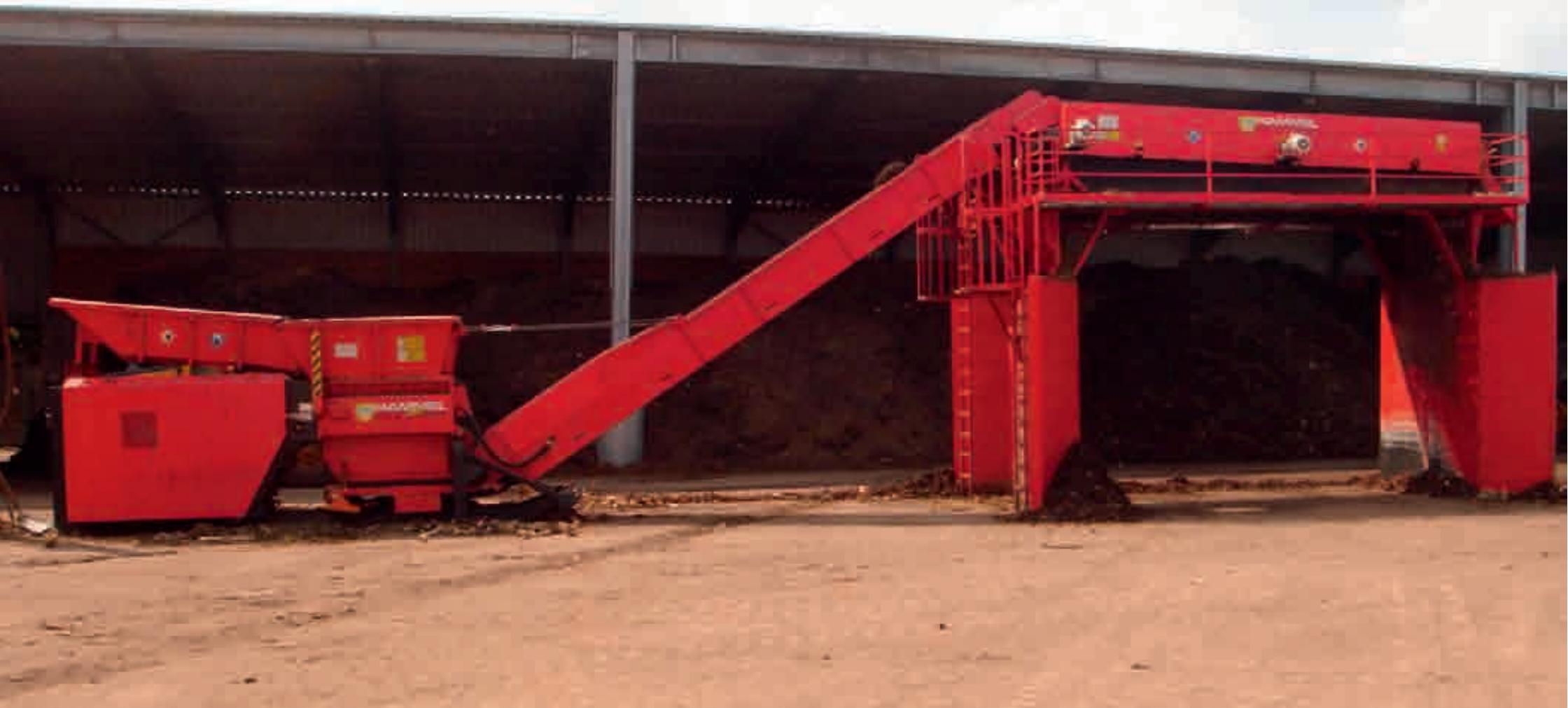
Das Material wird in den VB 750 E aufgegeben, vorzerkleinert und über das verlängerte Austragsband dem Stern-Scheiben-Sieb zugeführt. – Durch das Sieb wird das Material von der Feinanteilfraktion 0 bis 150 mm befreit und ausgetragen.
